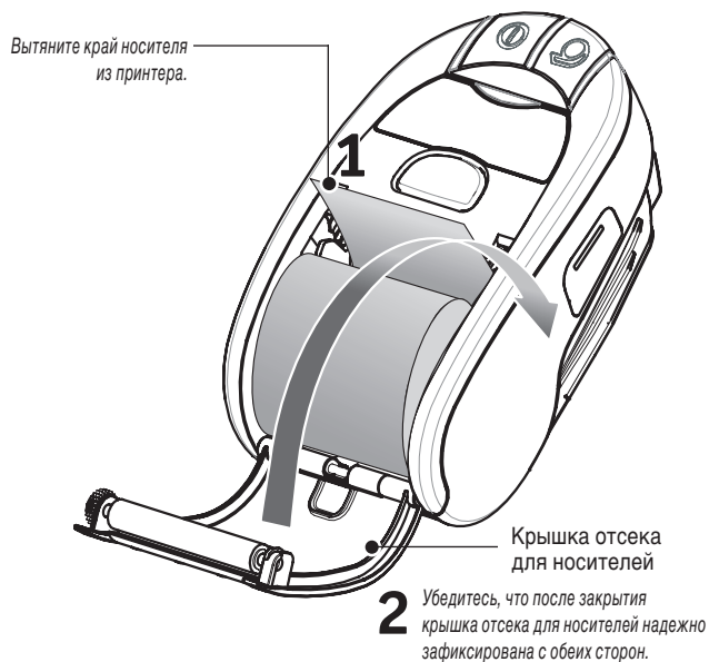
Рисунок 8. Закрытие крышки отсека для носителей.
